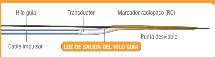
Diseño nuevo de punta desviable de Kodama
