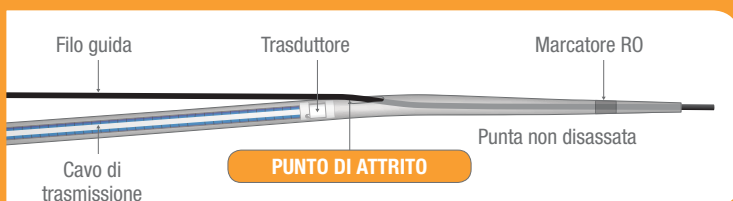
Struttura della punta del catetere IVUS standard
