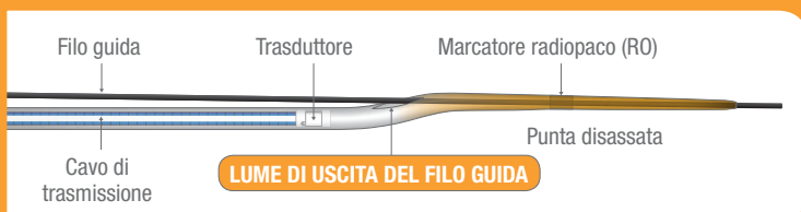
Struttura della nuova punta disassata di Kodama
